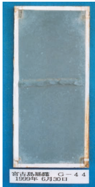
(2年経過時) 81μm(溶接ビード部有り)
