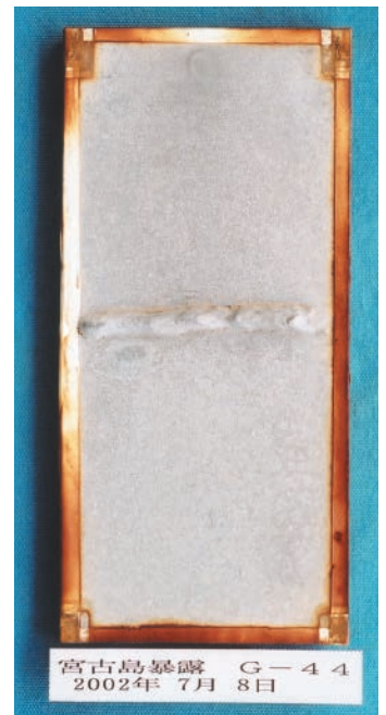
(2年経過時) 81μm(溶接ビード部有り)
